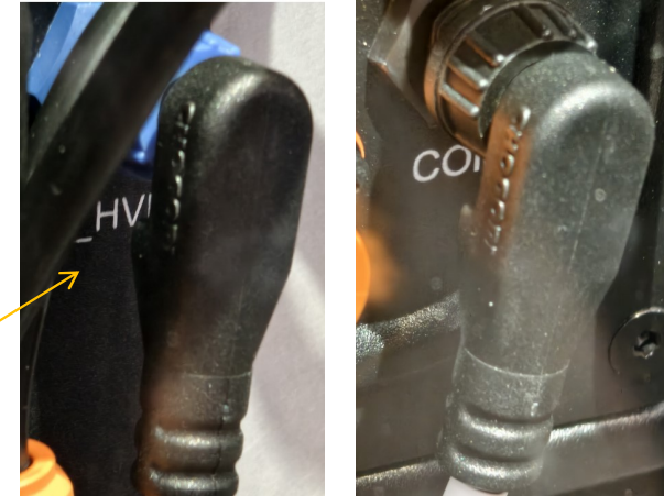
Mini 6pin Data Transmission 2A IP67
